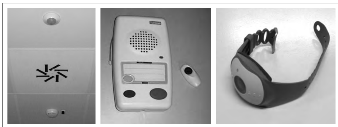
Fig. 8 Sensori ambientali di movimento e fumo, sistema di telesoccorso interfacciabile con numerosi tipi di rivelatori e sensori, bracciale indossabile per la rivelazione di alcuni parametri vitali che vengono trasmessi all'impianto domotico e all'esterno.
