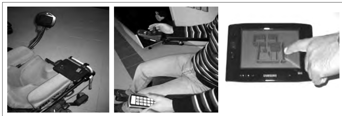
Fig. 6 Carrozzine elettroniche con centralina per il controllo ambiente e telecomando installato a bordo, tablet PC touchscreen con sw per il controllo del sistema domotico.
